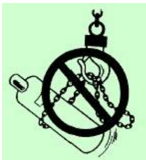
Fig. 2: Indicador de prohibición de utilización de cadenas o cables para transportar botellas de gas
