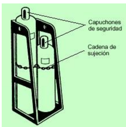
Fig. 1: Tipo de plataforma de transporte de botellas
